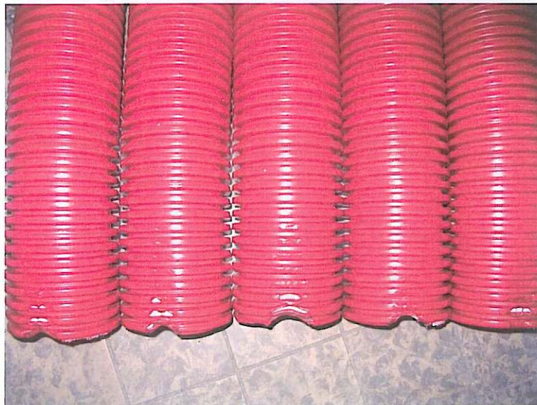
Abb. 2: PE Belüftungsrohre flexibel (rot) Muster 1: nach der Kantenbeflammung
