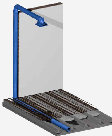
IN WERK GESTORTE VLOER
