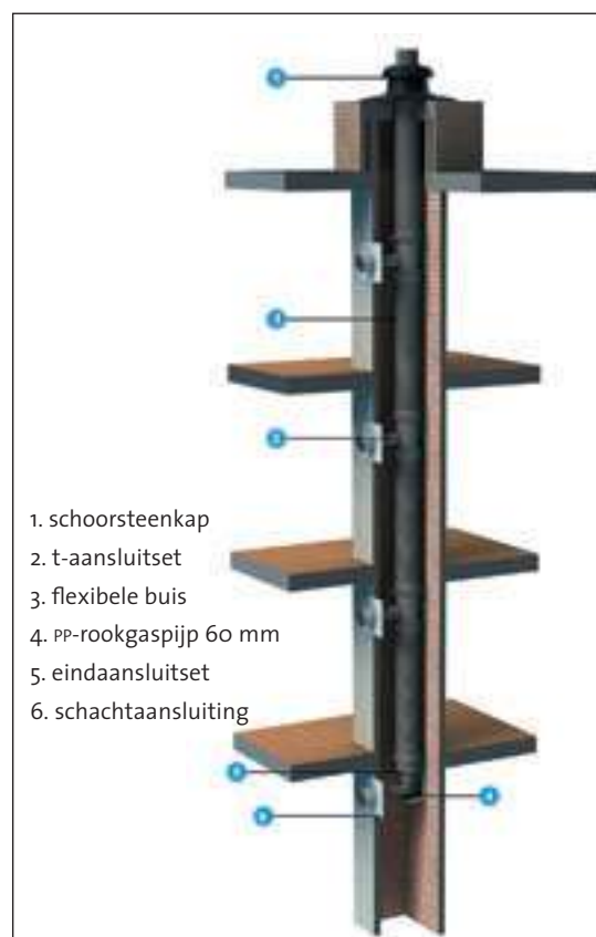
Het principe van de MultiFlex gemeenschappelijke rookgasafvoer.
