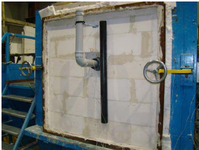
Foto 1 – Proefstuk aan de niet-direct verhitte zijde, voor aanvang van de brandproef
